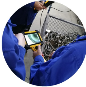
工件内部焊接检查
