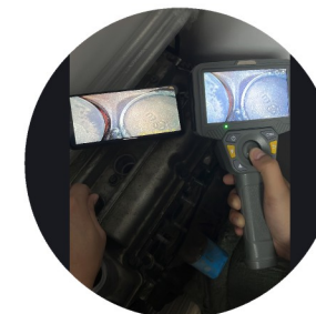
发动机内部积碳检查 手机内窥镜双屏显示
