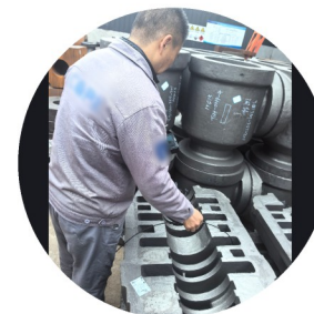
检测水泵内部流道
